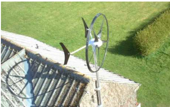
Obrázek 9.2: Malá větrná turbína (mikroturbín „Shift“ – zdroj „Zařízení na výrobu obnovitelné energie“)
