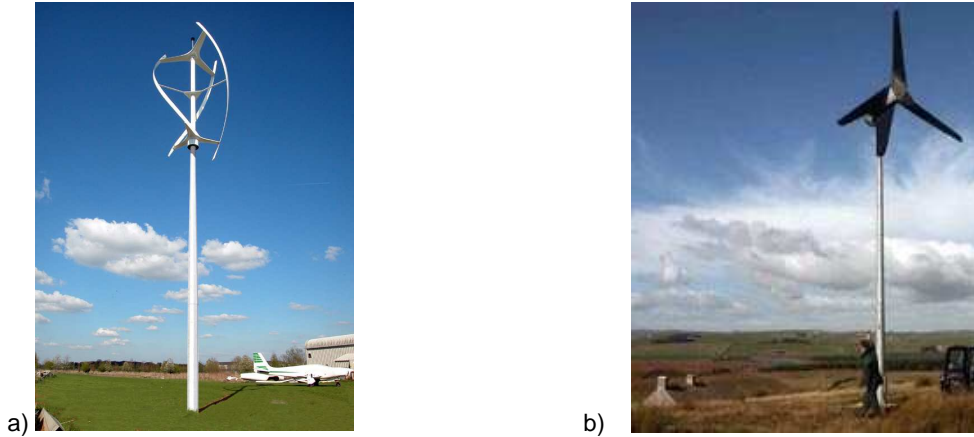
Obrázek 9.5: a) Větrná turbína se vísilou osou - Quite Revolution 5 – zdroj: XC02 Low Carbon Engineering b) Větrná turbína s vodorovnou osou – Proven WT6000 – zdroj: Proven Energy
