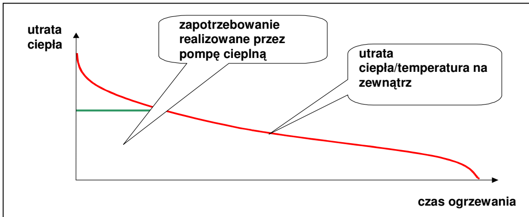
Rycina 7.2: Dobór odpowiedniej wielkości instalacji pompy ciepła
